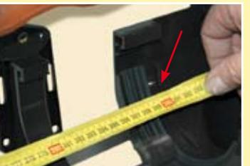
Измерьте длину желоба до обозначения "limit position".
